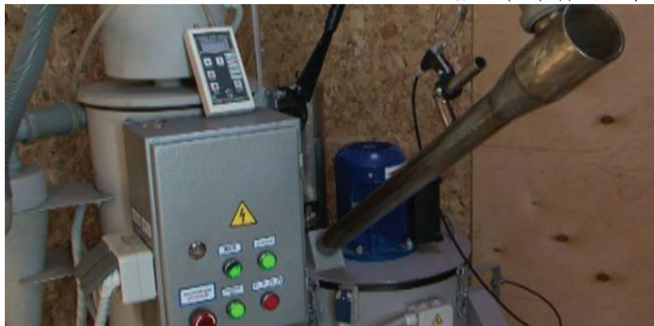
Прибор для переработки ртутных ламп
